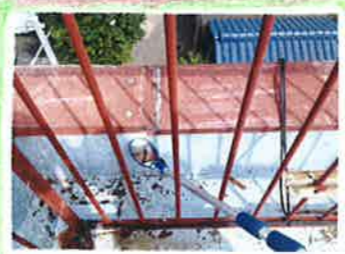
大型点検鏡を使って 隠れた所のひび割れ 等をチェックします。
